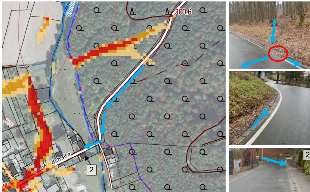
Abbildung 44: K40, Fließwege (blau), Straßeneinlauf (rot) und gefährdetes Gebäude
